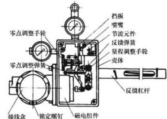
图2 HEP型定位器内部结构
