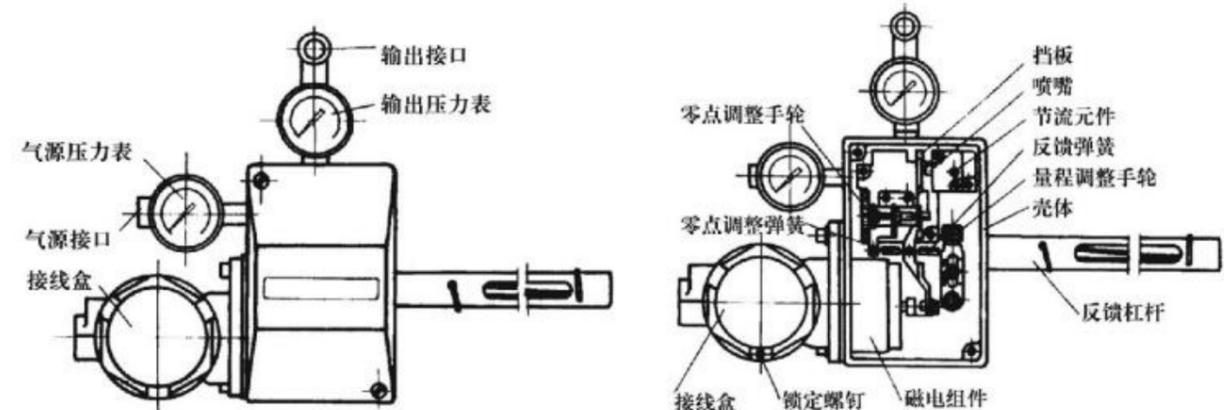
图1 HEP型定位器外形图
