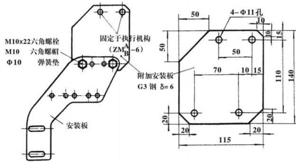
图9 定位器在ZM<sup>A</sup>-6型执行机构上用安装板
