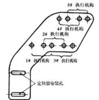
图8 ZM<sup>A</sup><sub>B</sub>型执行机构用安装板
