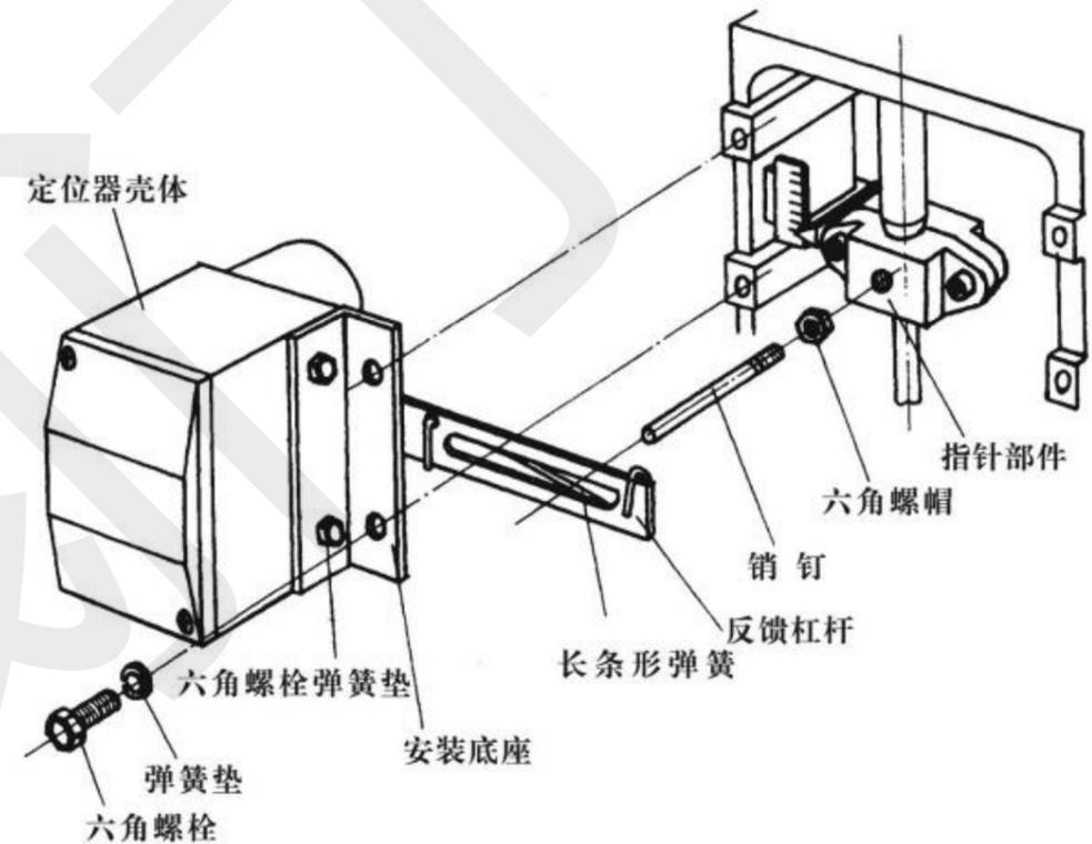
图4 定位器在ZHB<sup>A</sup>型执行机构上安装图
